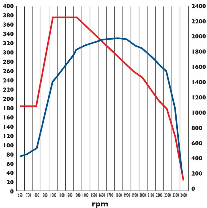
480 cv (353 kW) @ 1.600 a 1.900 rpm
